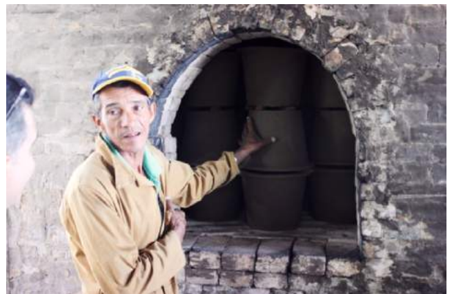
Foto 6: Un operaio ci mostra il forno in cui i filtri vengono cotti ad una temperatura di 850-900 gradi per la durata di 9 ore.
