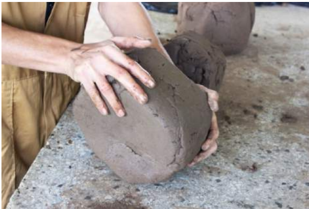
Foto 3: Operaio del CITA che lavora il composto di la pressa.
