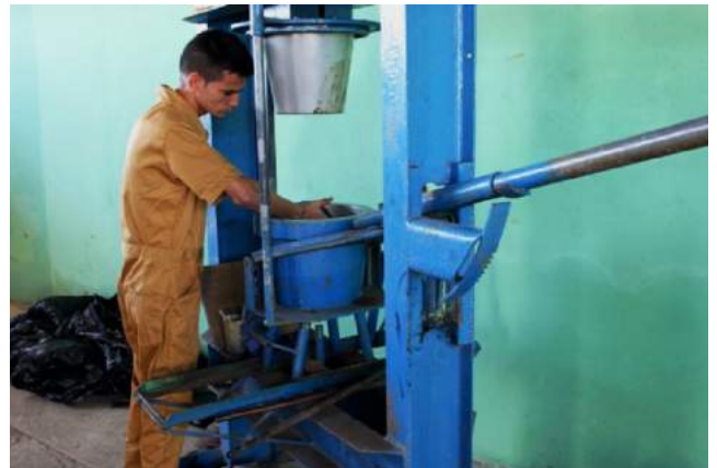
Foto 4: Operaio del CITA forma il futuro filtro con argilla, segatura e acqua.
