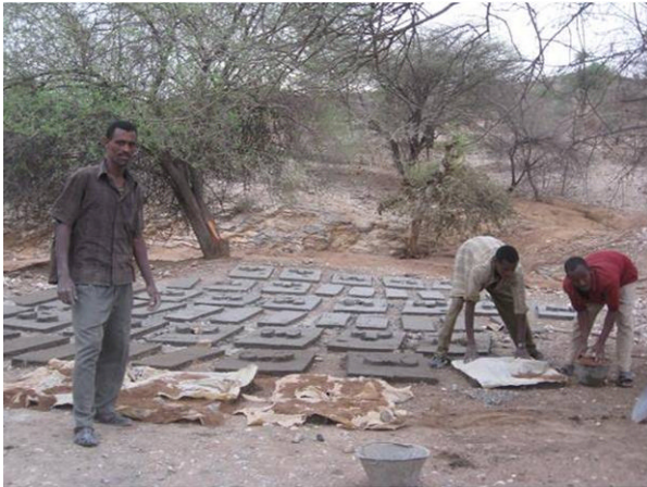
Lokale Handwerker stellen Latrinenplatten her
