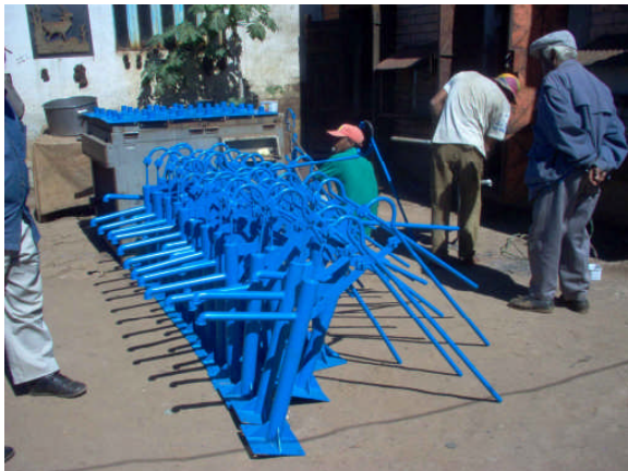
Lokal hergestellte Handpumpen (pompe à Ramah), die bei allen Brunnen eingesetzt werden
